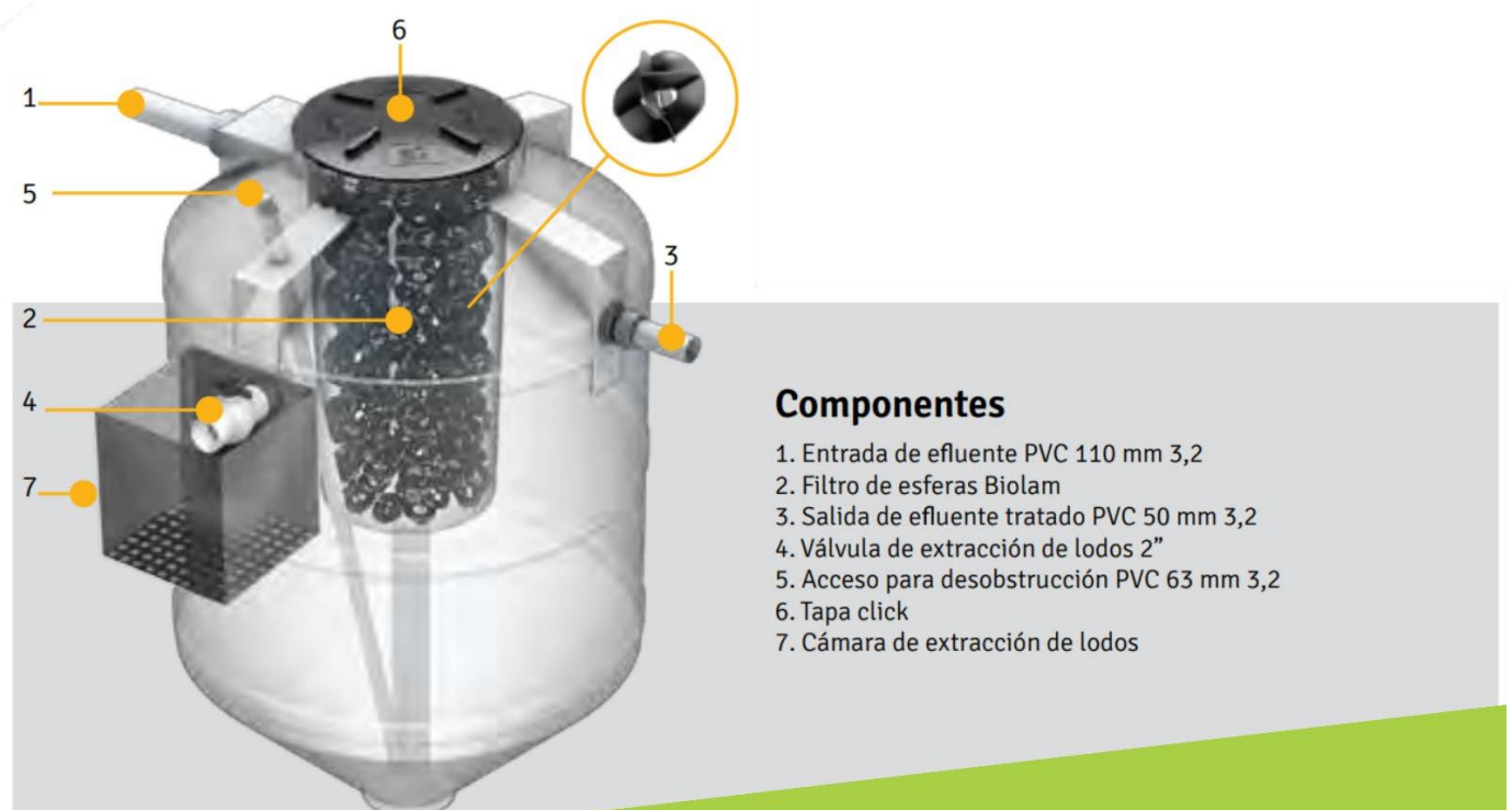
Figura 1: Componentes de un Biodigestor. Manual del Biodigestor Autolimpiable Rotoplas. Pag. 5. www.rotoplas.com.ar
